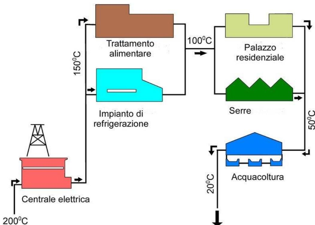
**Figura 20:** Esempio di utilizzazione a cascata dei fluidi geotermici (Per cortesia del Geo-Heat Center, Klamath Falls, Oregon, USA).
