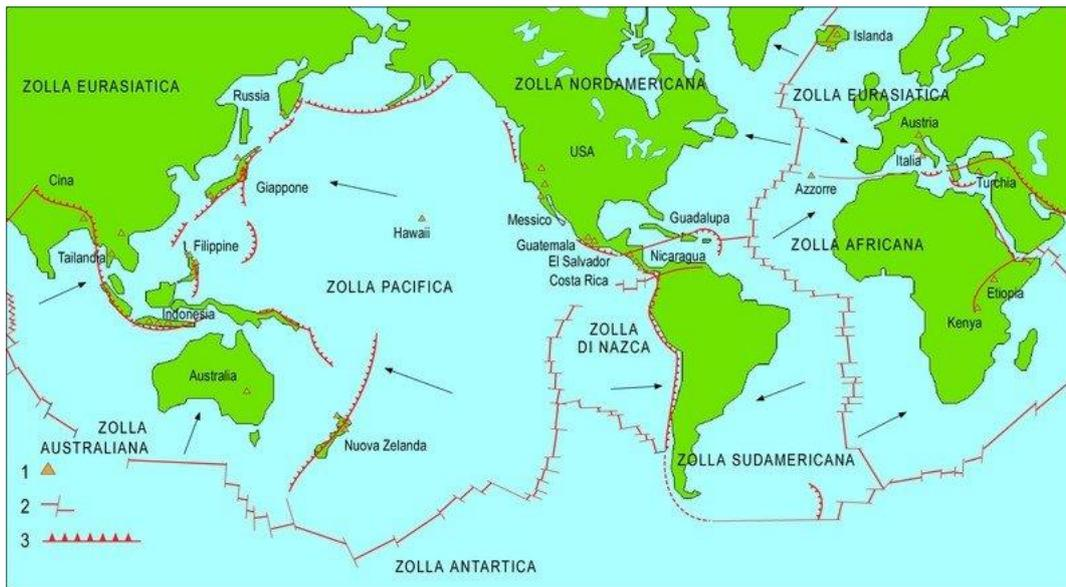
**Figura 5:** zolle crostali, dorsali, fosse oceaniche, zone di subduzione e campi geotermici. Le frecce indicano la direzione del movimento delle zolle. (1) Campi geotermici che producono elettricità; (2) dorsali interrotte dalle faglie trasformati (fratture trasversali); (3) zone di subduzione, nelle quali la litosfera volge in basso verso l'astenosfera, dove fonde.
