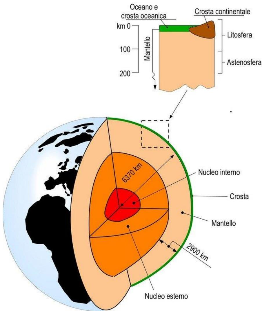
**Figura 1:** schema della struttura interna della Terra: crosta, mantello e nucleo. A destra in alto, un dettaglio della crosta e della parte superiore del mantello.
