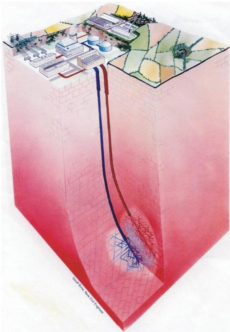
**Figura 8:** rappresentazione schematica di un sistema geotermico artificiale (Rocce Calde Secche).
