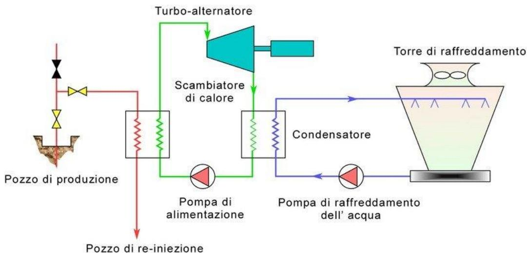
**Figura 13:** rappresentazione schematica di un impianto a ciclo binario per generazione di elettricità. In rosso il circuito del fluido geotermico, in verde il circuito del fluido secondario, in blu il circuito di raffreddamento.
