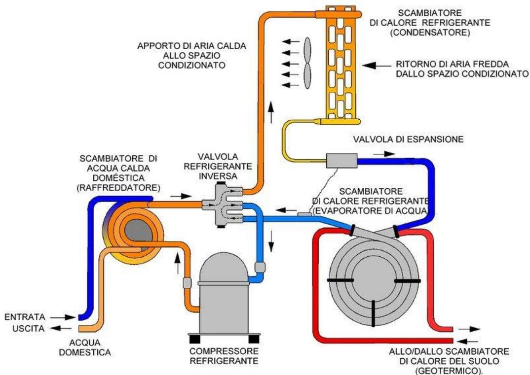
**Figura 16:** Schema di pompa di calore in posizione di riscaldamento (per cortesia del Geo-Heat Center, Klamath Falls, Oregon, USA).
