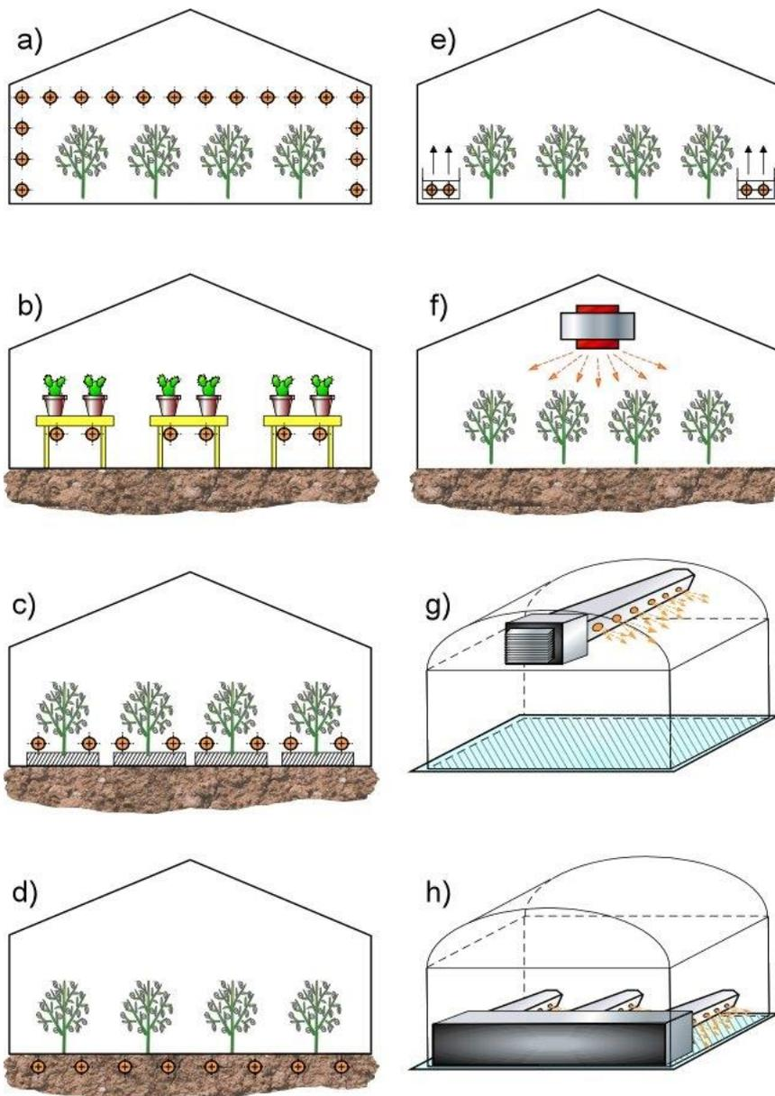
**Figura 18:** Sistemi di riscaldamento delle serre geotermiche. Riscaldamento a convezione naturale: (a) tubi sospesi, (b) pancali riscaldati, (c) tubi posizionati in basso. Riscaldamento del terreno (d). Riscaldamento ad aria forzata: (e) convettori laterali, (f) ventilatori sospesi, (g) convettori posizionati in alto, (h) convettori posizionati in basso.
