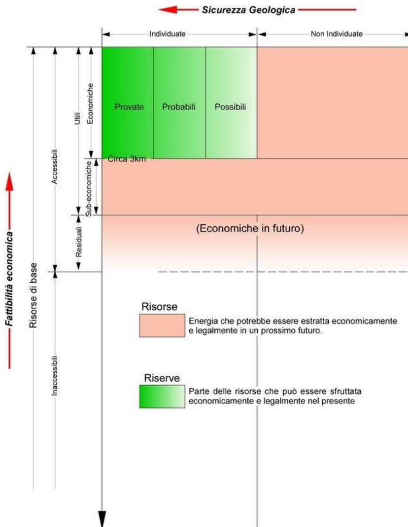
**Figura 9:** diagramma con le diverse categorie di risorse geotermiche (da Muffler e Cataldi, 1978). L'asse verticale indica il grado di fattibilità economica; l'asse orizzontale il grado di sicurezza geologica.
