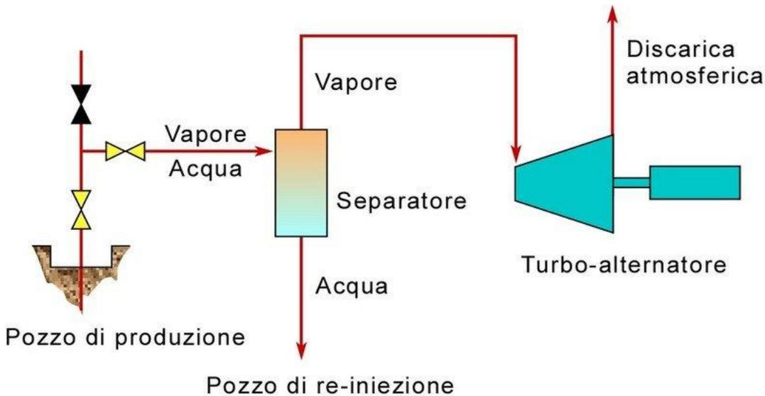
**Figura 11:** rappresentazione schematica di un impianto a contropressione per generazione di elettricità. In rosso il circuito del fluido geotermico.
