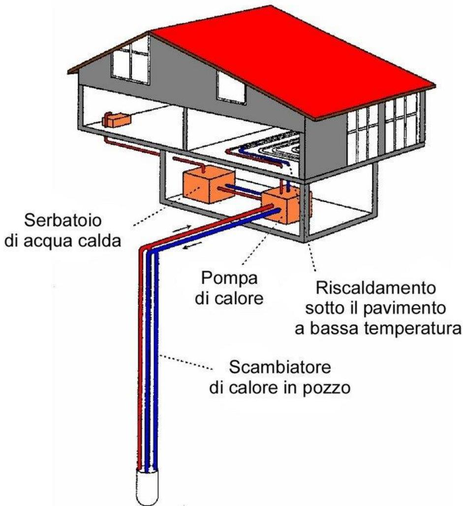
**Figura 15:** Esempio di sistema di riscaldamento domestico con pompa di calore connessa al terreno (da Sanner et al., 2003).
