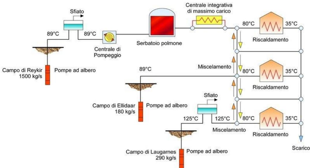
**Figura 14:** Schema semplificato del sistema di riscaldamento geotermico di un complesso di edifici a Reykjavik, Islanda (da Gudmundsson, 1988).
