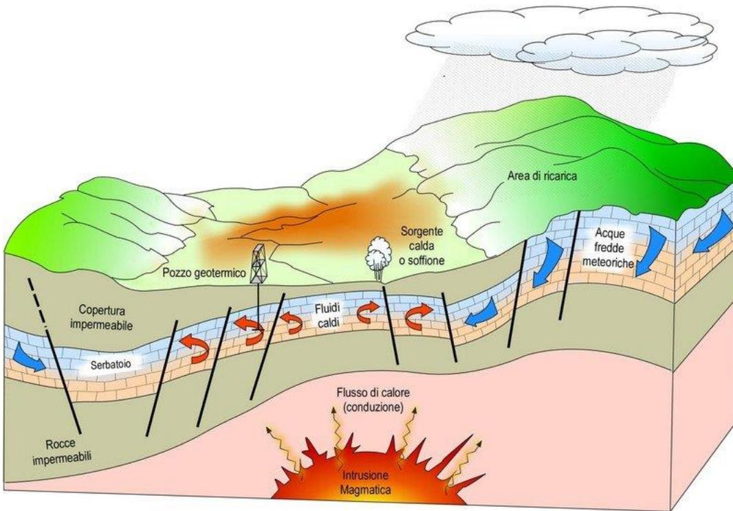
**Figura 6:** rappresentazione schematica di un sistema geotermico.
