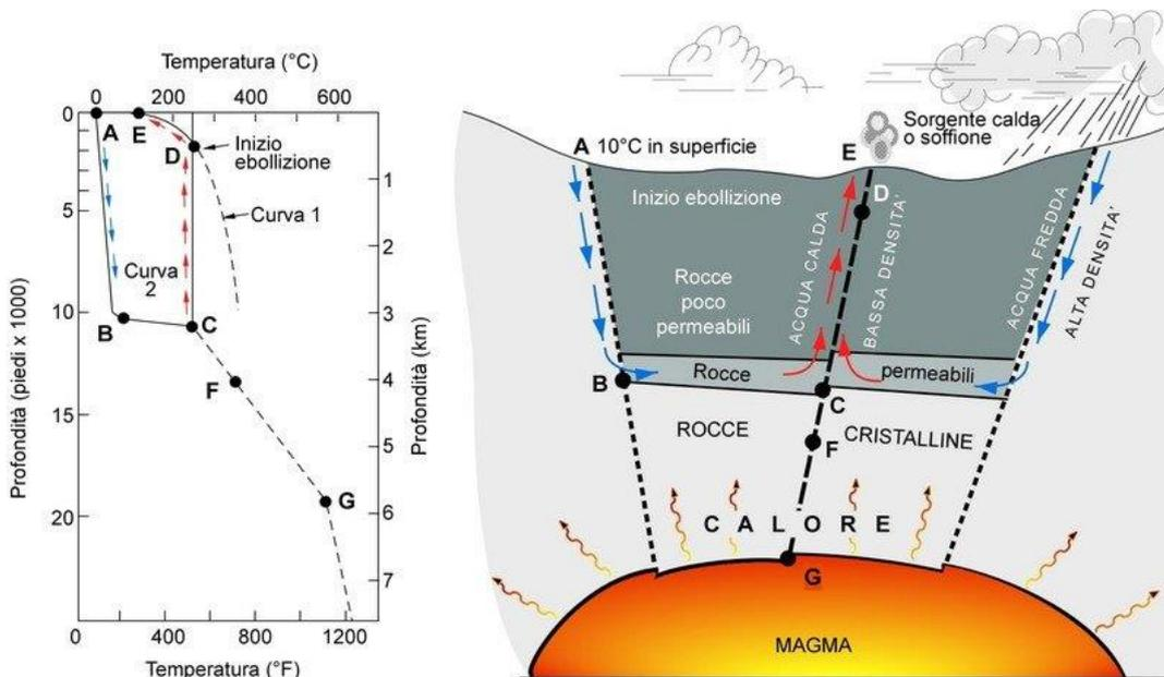
**Figura 7:** modello di un sistema geotermico. La curva 1 è la curva di ebollizione dell'acqua; la curva 2 mostra l'andamento della temperatura del fluido lungo il suo percorso dal punto di ingresso A a quello di uscita E.
