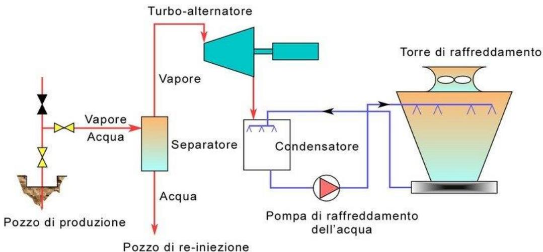
**Figura 12:** rappresentazione schematica di un impianto a condensazione per generazione di elettricità. In rosso il circuito del fluido geotermico, in blu il circuito di raffreddamento.
