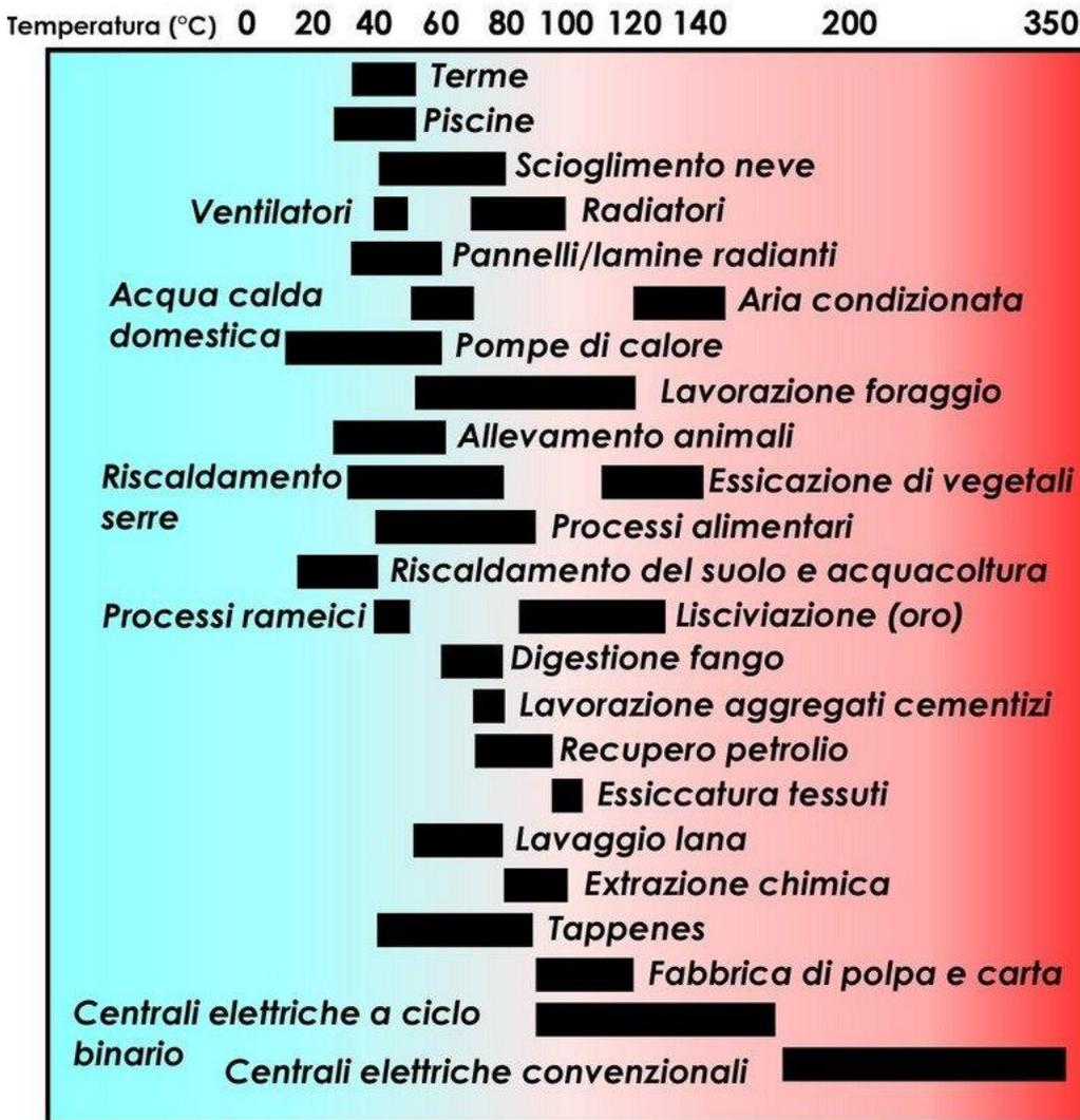
**Figura 10:** diagramma con l'utilizzazione dei fluidi geotermici (derivato da Lindal, 1973).
