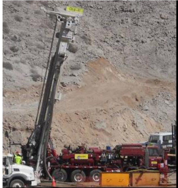
Fig. 5 : Vista dell'impianto usato per la perforazione del pozzo del "Plan B"
