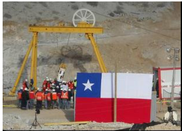
Fig. 11: Sistema di discesa e sollevamento della capsula
