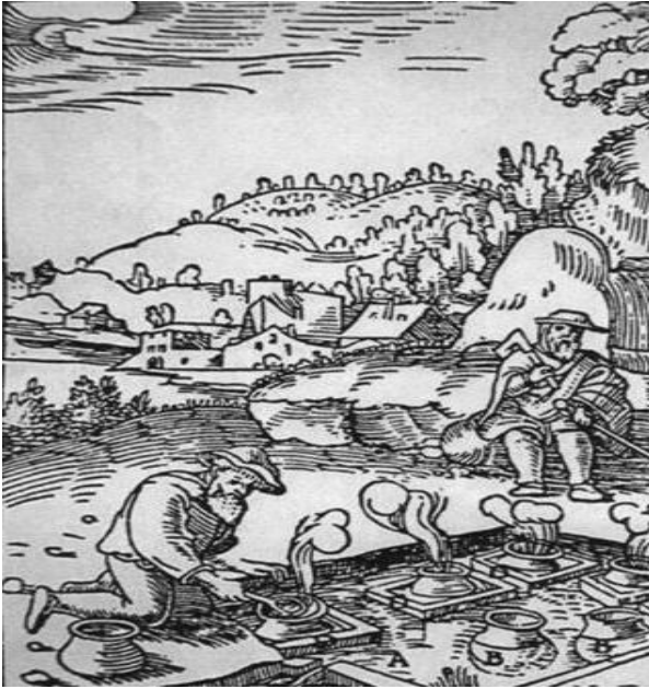
Fig. 1: Estrazione di prodotti borici per evaporazione e concentrazione di salamoie geotermiche dalle acque dei lagoni vicino a Larderello (da De Re Metallica, di Agricola; Tomo XII, pag. 479 ).
