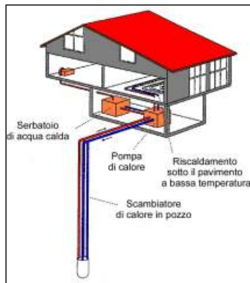
Fig 9: esempio di sistema di riscaldamento domestico con pompa di calore connessa al terreno (da Sanner et al., 2003).
